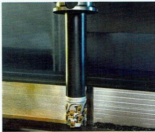
erzeugen sehr gute Oberflächenqualitäten. Vier segmentierte, wendelförmige Hauptschneiden der Reihe sollen dem Anwender eine ganze Reihe von Vorteilen bringen. Sie erzeugen kurze Späne mit kleinem Querschnitt, die sich sehr gut abführen lassen. Geringe Schnittkräfte reduzieren
