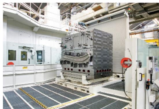
**03** Auf diesen Spannkubus aus Stahl werden zu fräsende Fahrwerksaufhängungen aus Titan gespannt. Bis zu 28 t wiegt der gesamte Aufbau, den der Peiseler-Drehtisch mühelos bewegt
