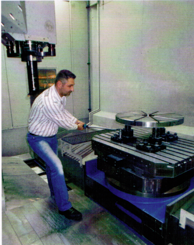
▲ Ein Palettentisch von Peiseler positioniert die zu bearbeitende Planscheibe in höchster Geschwindigkeit und Genauigkeit
