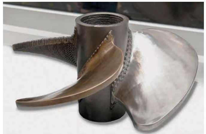
Eine mit dem 3DMP-Verfahren generativ gefertigte Schiffsschraube: Der hintere Flügel ist noch nicht final bearbeitet und zeigt deutlich die mit dem geschmolzenen Draht aufgetragenen Lagen
