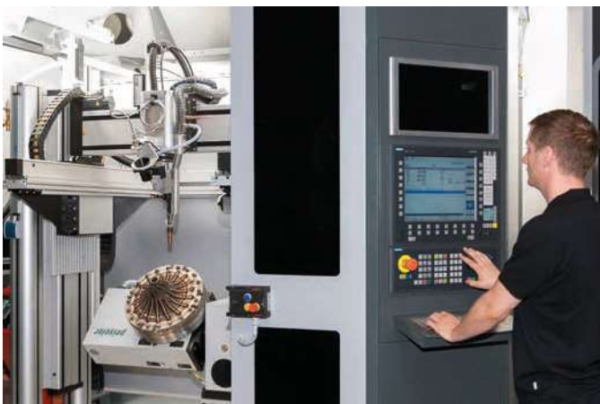
Generative Fertigung eines Impellers, den die Zweiachs-Schwenkeinrichtung ZATC 300 in Sekundenschnelle für die Bearbeitung positioniert (Bilder: Peiseler)
