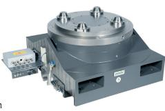
Bild: Der ATD 800 ist einer von zunächst fünf Rundtischen, die Peiseler mit einem neuen Kühlkonzept ausstattet. Diese Neuentwicklung ermöglicht einen permanenten Drehbetrieb. Damit ist dieses Teilgerät dauerhaft und thermisch stabil sowohl für das Fräsen als auch das Drehen zu nutzen (Werkbild: Peiseler GmbH & Co. KG, Remscheid)
