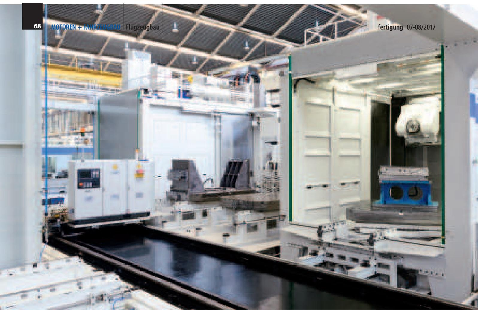
Beim Fräsen der Strukturkomponenten für verschiedene Flugzeuge gilt es, die Titan-Werkstücke in Sekundenschnelle hochpräzise in Position zu bringen.
