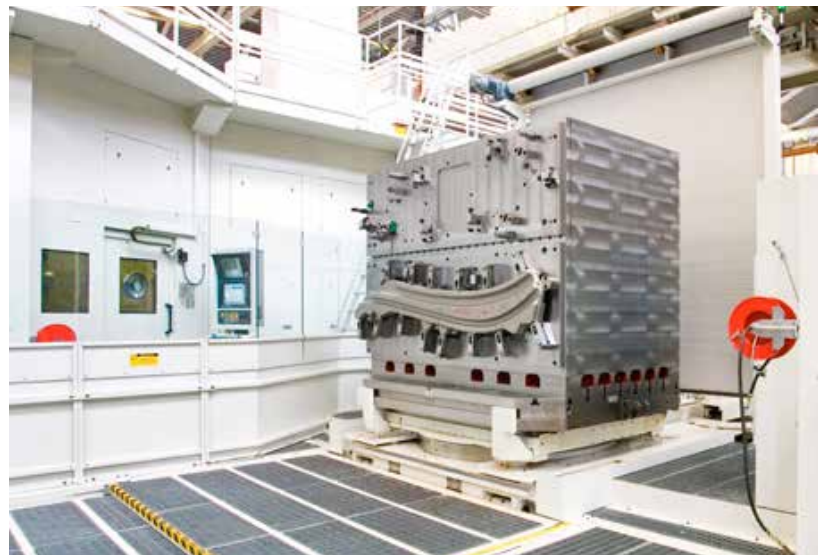
oben Beim Fräsen der Strukturkomponenten für verschiedene Flugzeuge gilt es, die Titan-Werkstücke in Sekundenschnelle hochpräzise in Position zu bringen. (Bild: Premium Aerotec)
