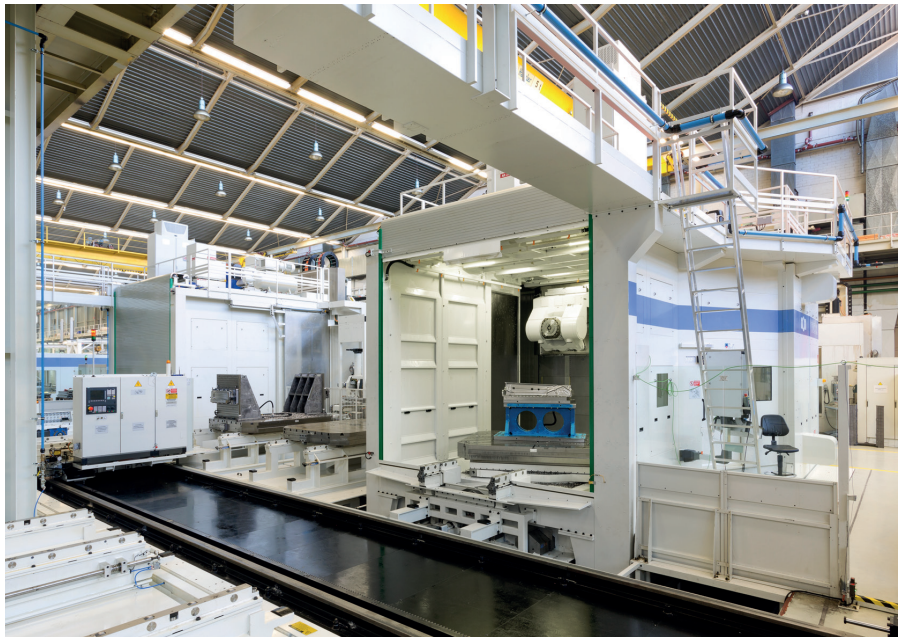
Bild 2: Beim Fräsen der Strukturkomponenten für verschiedene Flugzeuge gilt es, die Titan-Werkstücke in Sekundenschnelle hochpräzise in Position zu bringen
