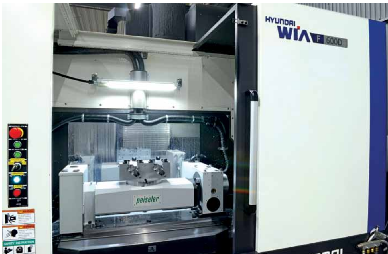
Bild 1: Die Peiseler-Schwenkeinrichtung in der Werkzeugmaschine von Hyundai WIA bei AVCI in Solingen. Erstmals setzte das Remscheider Unternehmen mit dieser Lösung eine mittig platzierte Planscheibe um und realisiert damit einen größeren Störkreis
