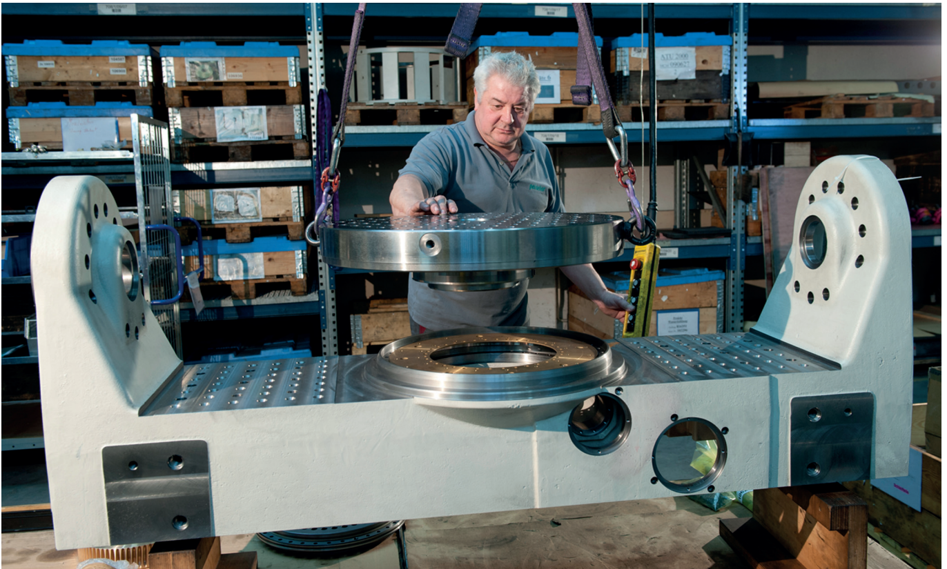
Bild 1: Ein Peiseler-Mitarbeiter bei der Montage einer Zweiachs-Schwenkeinrichtung, die zu den Top-Produkten des Unternehmens gehört
