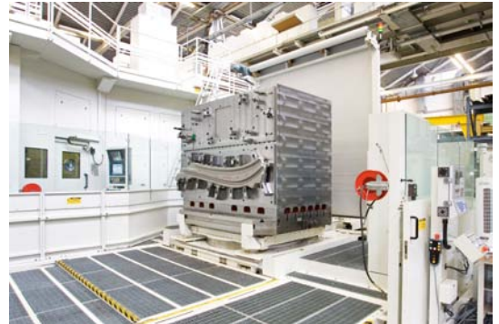
Auf diesem Spannkubus aus Stahl sind die zu bearbeitenden Teile montiert. Bis zu 28 Tonnen wiegt der gesamte Aufbau, den der Peiseler-Drehtisch mühelos bewegt. (Bild: Premium Aerotec)
