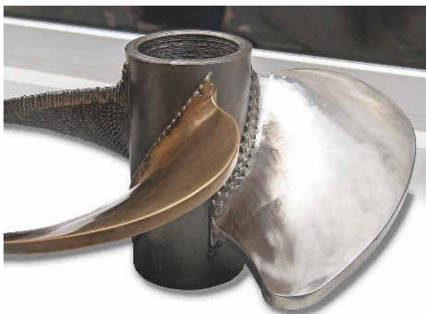
*Eine durch 3DMP generativ gefertigte Schiffschraube. Der hintere Flügel ist noch nicht final bearbeitet und zeigt die mit dem geschmolzenen Draht aufgetragenen Lagen.*
