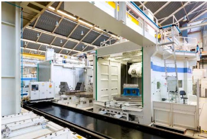
*Beim Fräsen der Strukturkomponenten für verschiedene Flugzeuge gilt es, die Titan-Werkstücke in Sekundenschnelle hochpräzise in Position zu bringen. Bilder: Premium Aerotec*
