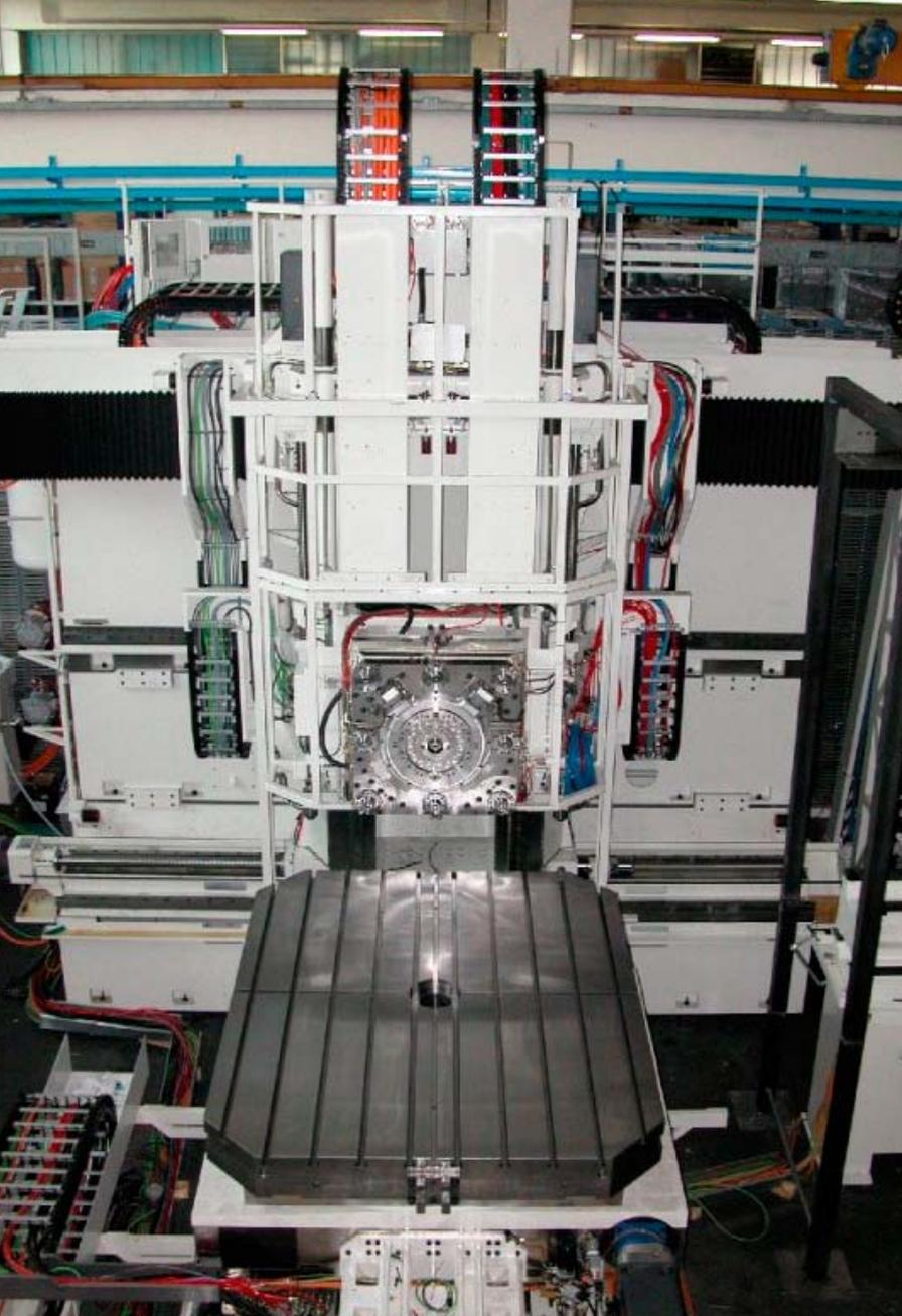
Der Peiseler-Drehtisch ATU 2000 ist eine zentrale Komponente in der MCM-Werkzeugmaschine von Premium Aerotec in Augsburg. Bild: MCM
