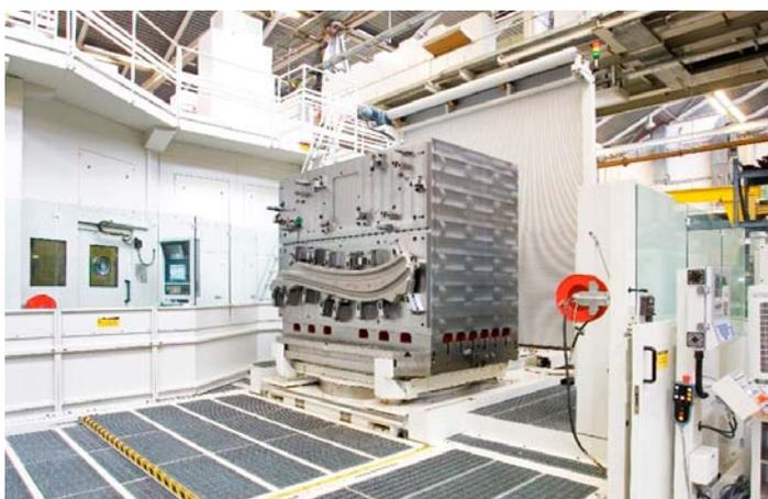
*Auf diesen Spannbus aus Stahl spannen Mitarbeiter von Premium Aerotec die zu bearbeitenden Teile. Bis zu 28 t wiegt der gesamte Aufbau, den der Peiseler-Drehtisch mühelos bewegt.*
