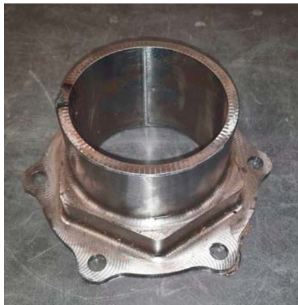
Entstehung eines Flansches auf der Mobile Smart Factory (MSF) in Stationen. Auf das 3D-Drucken durch Lichtbogen-Auftragsschweißen WAAM folgt das Fräsen und dann die Fertigbearbeitung.
