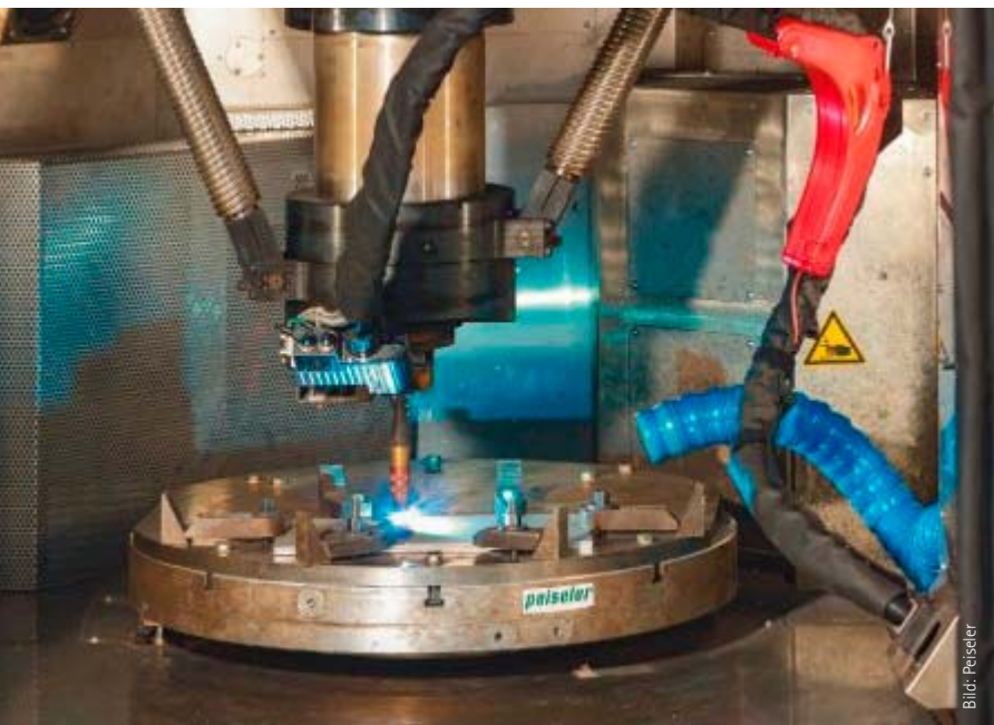
Beim 3D-Druck kommt das Wire Arc Additive Manufacturing (WAAM) zum Einsatz: Mit einem Lichtbogen-Schweißgerät wird ein Metalldraht aufgeschmolzen und so nach und nach das Bauteil generiert.
