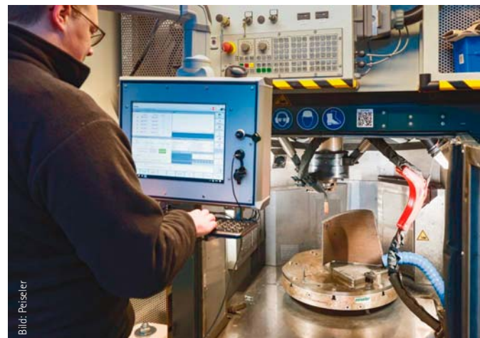
Programmierung für die Fertigung eines Rührflügels, der auf dem Peiseler-Rundtisch in der Mobile Smart Factory montiert ist.
