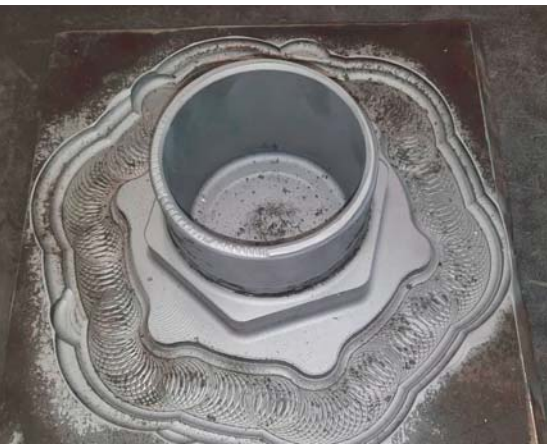
Entstehung eines Flansches auf der Mobile Smart Factory (MSF) in Stationen. Auf das 3D-Drucken durch Lichtbogen-Auftragsschweißen WAAM folgt das Fräsen und dann die Fertigbearbeitung.
