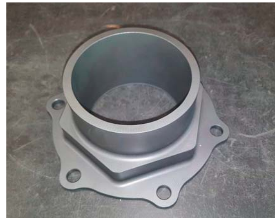
Entstehung eines Flansches auf der Mobile Smart Factory (MSF) in Stationen. Auf das 3D-Drucken durch Lichtbogen-Auftragsschweißen WAAM folgt das Fräsen und dann die Fertigbearbeitung.
