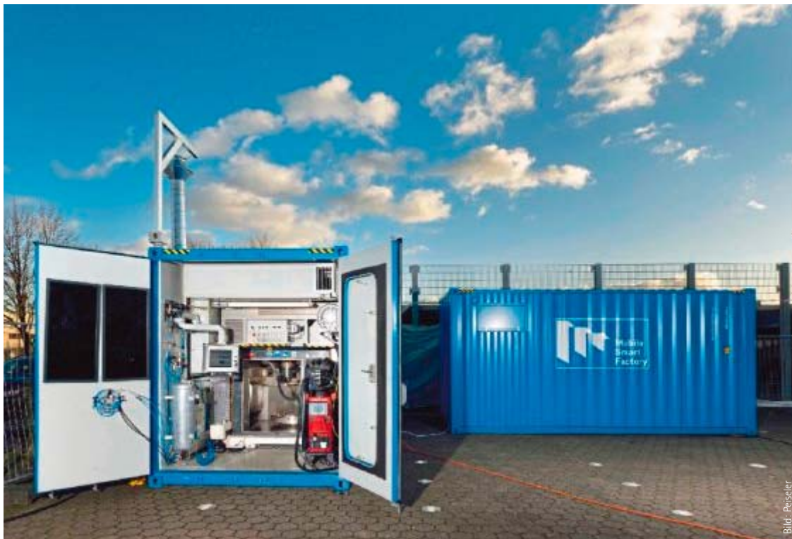
Die Mobile Smart Factory besteht aus zwei Containern. Einem mit der Anlage für 3D-Druck und Fräsarbeiten sowie dem Peiseler-Rundtisch zur Positionierung der Werkstücke. Der andere zur Arbeitsvorbereitung und Steuerung.
