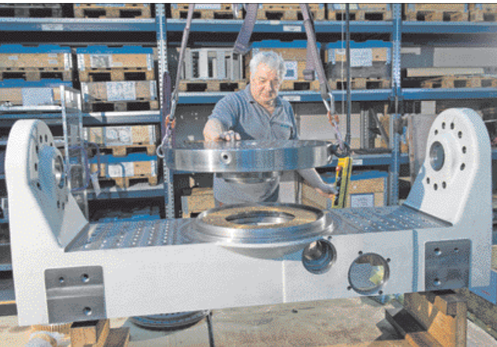
Ein Peiseler-Mitarbeiter bei der Montage einer Zweiachs-Schwenkeinrichtung, die zu den Top-Produkten des Unternehmens gehört.
