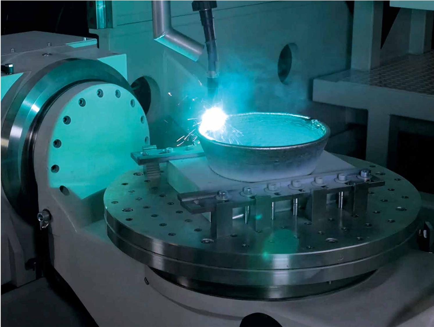
gebracht, das völlig neue Möglichkeiten erschließt und erhebliche Vorteile aufweist. Anders als bei den bislang eingesetzten pulverbasierten Verfahren, erfolgt der Druck mit dem bewährten Lichtbogenschweißen und Draht. Der geschmolzene Schweißzusatzwerkstoff wird lagenweise aufgetragen und generiert so das metallische Bauteil.
