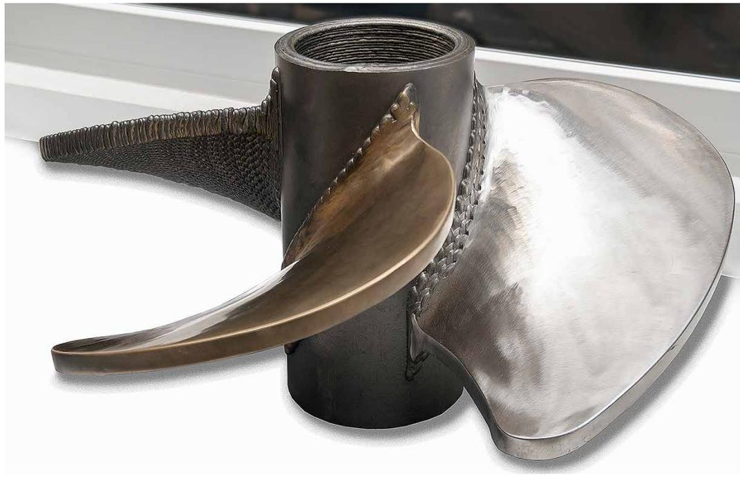
**Eine mit dem 3DMP-Verfahren generativ gefertigte Schiffsschraube. Der hintere Flügel ist noch nicht final bearbeitet und zeigt deutlich die mit dem geschmolzenen Draht aufgetragenen Lagen.**
