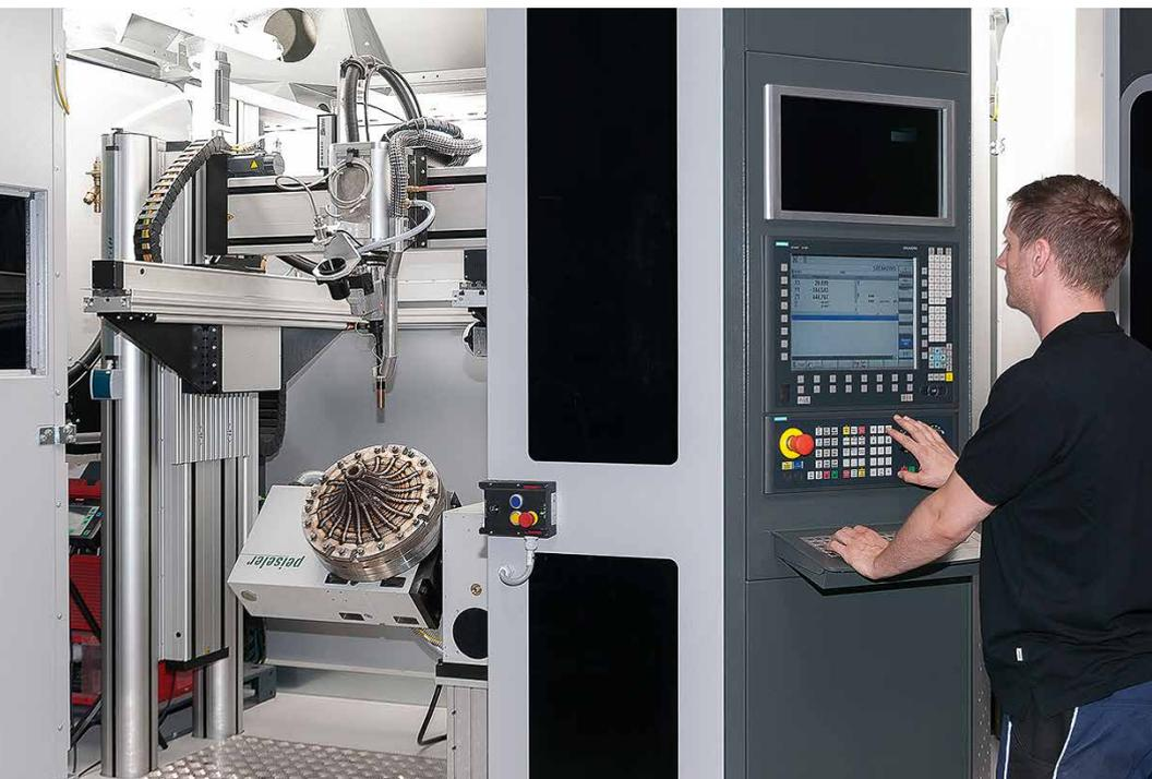
davon dient anschließend für die Programmierung der Maschine, wo der lagenweise Aufbauprozess mit Lichtbogenschweißen und Draht erfolgt.
