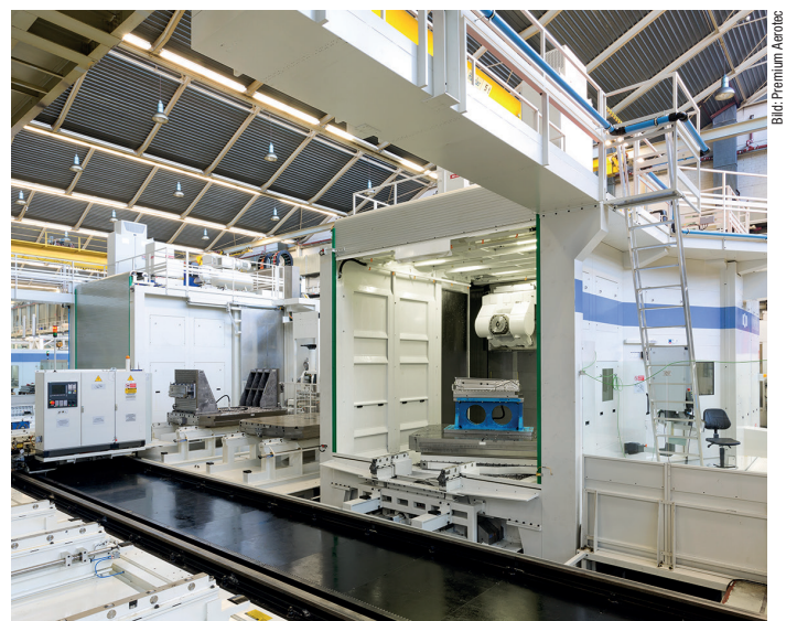
Beim Fräsen der Strukturkomponenten für verschiedene Flugzeuge gilt es, die Titan-Werkstücke in Sekundenschnelle hochpräzise in Position zu bringen.
