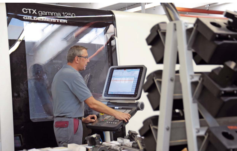
Ein Peiseler-Mitarbeiter programmiert die Fertigung in einem Bearbeitungszentrum
