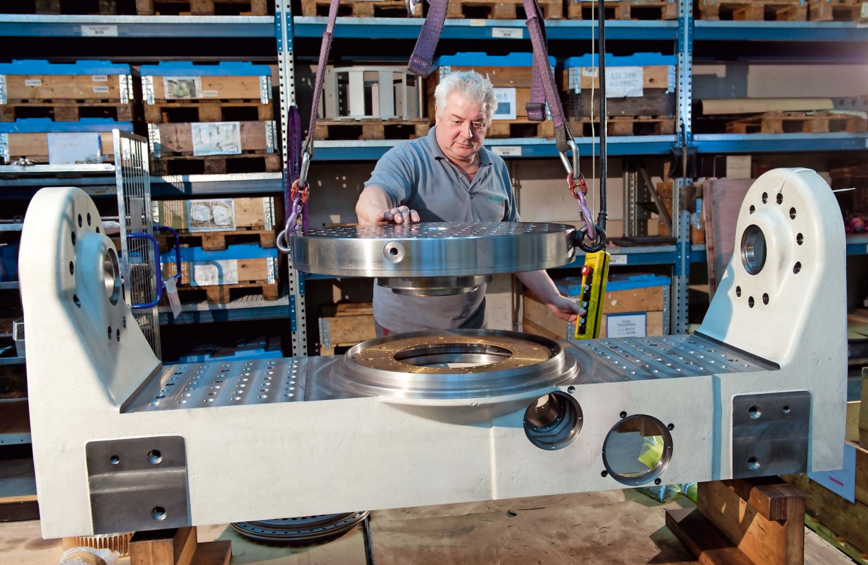
Ein Peiseler-Mitarbeiter bei der Montage einer Zweiachs-Schwenkeinrichtung, die zu den Top-Produkten des Unternehmens gehört
