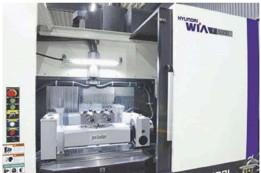
Die Peiseler-Schwenkeinrichtung in der Werkzeugmaschine von Hyundai WIA bei AVCI in Solingen. Erstmals setzte das Remscheider Unternehmen mit dieser Lösung eine mittig platzierte Planscheibe um und realisierte damit einen größeren Störkreis. Bild: Peiseler
