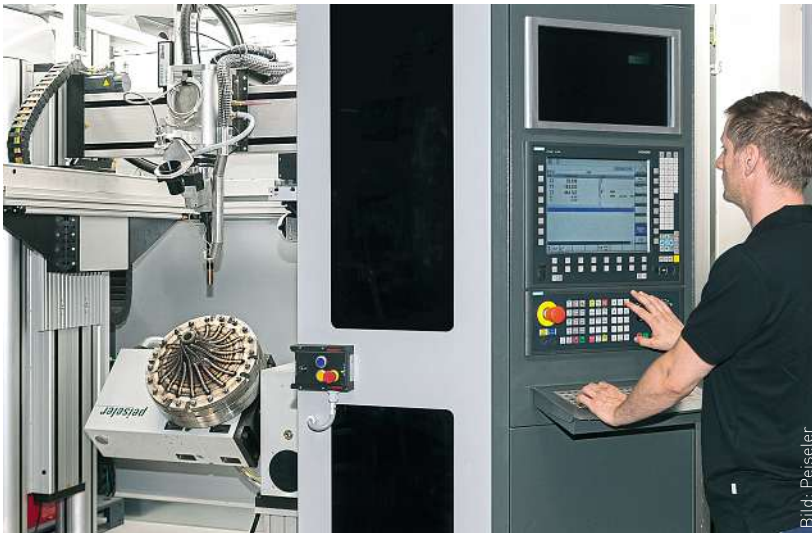
Ein Mitarbeiter bedient die 3DMP-Maschine arc 405 von Gefertec mit der 2-Achs-Schwenkeinrichtung ZATC 300 von Peiseler. Die Steuerung ist von Siemens.
