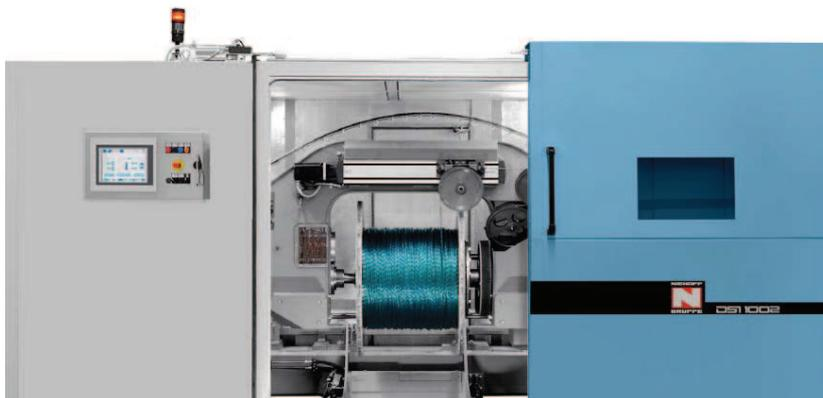
LK Metall liefert eine qualitativ hochwertige Schallschutzkabine für die Doppelschlag-Verseilmachine DSI 1002 von Niehoff.
