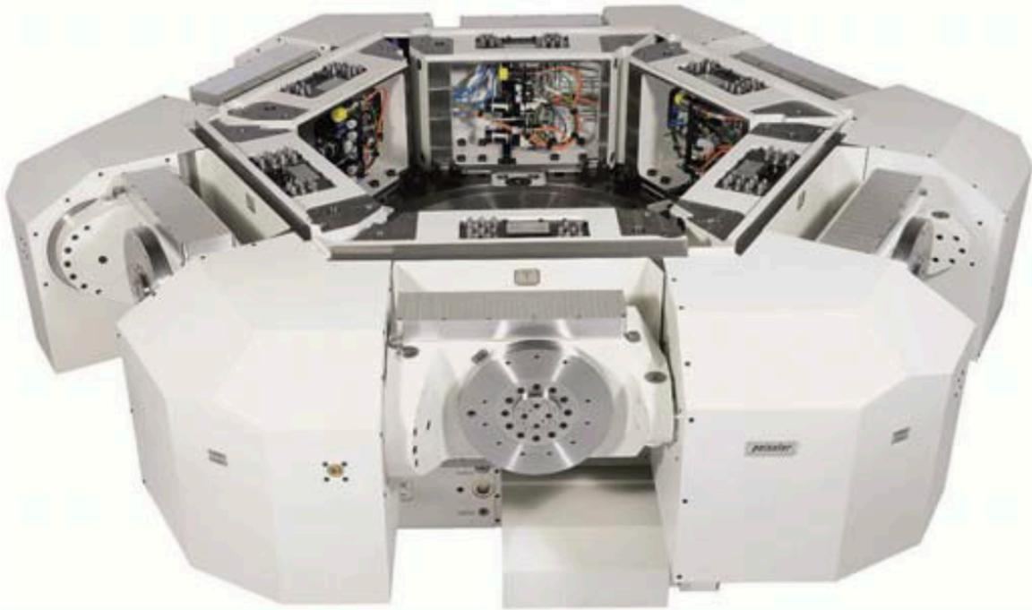
Der Rundtaktisch von Peiseler verfügt über sechs Zweiachs-Schwenkeinrichtungen vom Typ ZATC 300, die auf dem Basistisch ATU 1600 rotieren.
