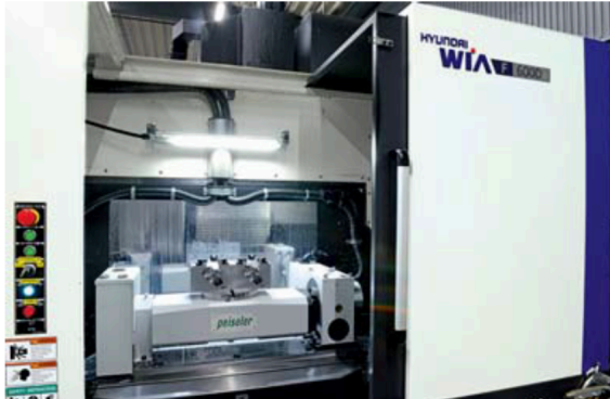
Die Peiseler-Schwenkeinrichtung in der Werkzeugmaschine von Hyundai WIA bei AVCI in Solingen.
