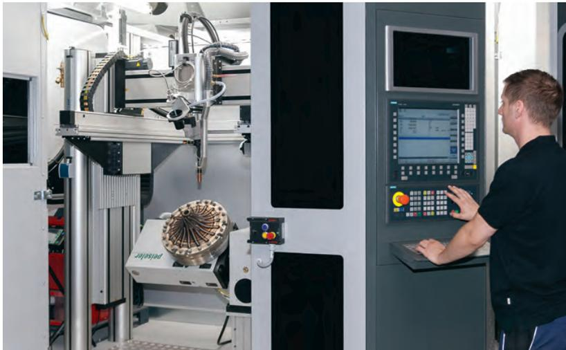
Ein Mitarbeiter bedient die 3DMP-Maschine arc 405 von Gefertec mit der Zweiachs-Schwenkeinrichtung ZATC 300 von Peiseler. Die bedienerfreundliche Steuerung stammt von Siemens. (Bild: Peiseler)
