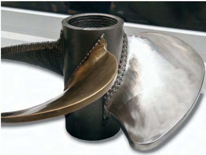
Eine mit dem 3DMP-Verfahren generativ gefertigte Schiffsschraube. Der hintere Flügel ist noch nicht final bearbeitet und zeigt deutlich die mit dem geschmolzenen Draht aufgetragenen Lagen. (Bild: Peiseler)
