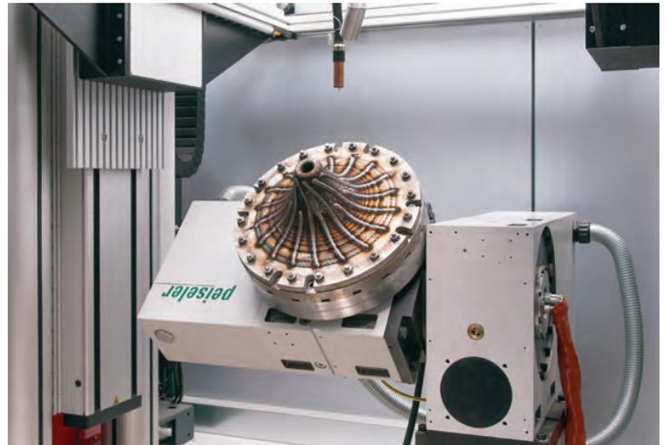
Generative Fertigung eines Impellers, den die Zweiachs-Schwenkeinrichtung ZATC 300 von Peiseler in Sekundenschnelle für die Bearbeitung positioniert. (Bild: Peiseler)
