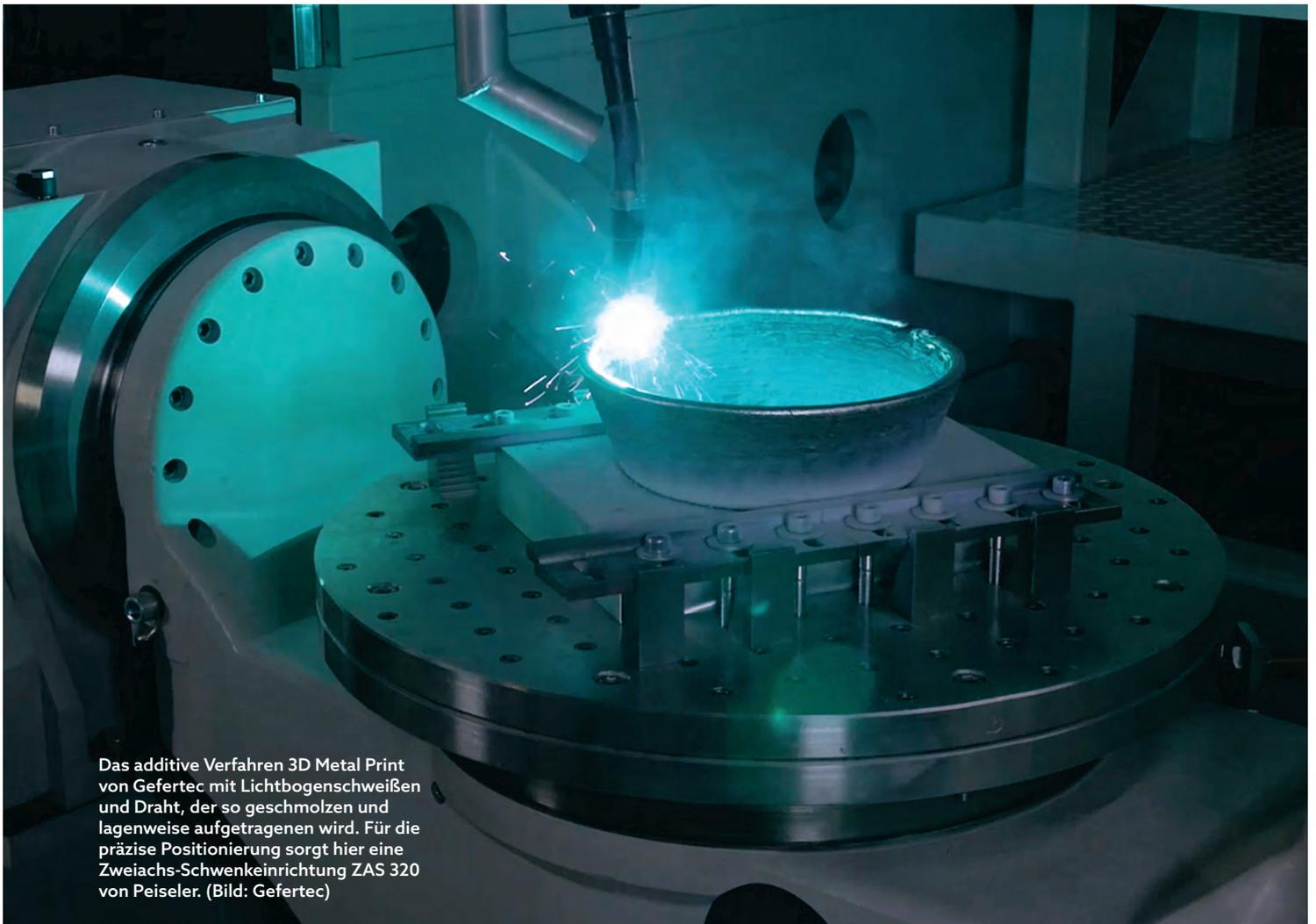
Das additive Verfahren 3D Metal Print von Gefertec mit Lichtbogenschweißen und Draht, der so geschmolzen und lagenweise aufgetragen wird. Für die präzise Positionierung sorgt hier eine Zweiachs-Schwenkeinrichtung ZAS 320 von Peiseler. (Bild: Gefertec)
