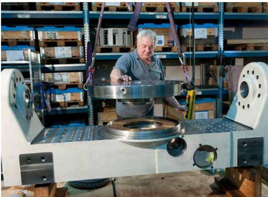
Ein Peiseler-Mitarbeiter bei der Montage einer Zweiachs-Schwenkeinrichtung.
