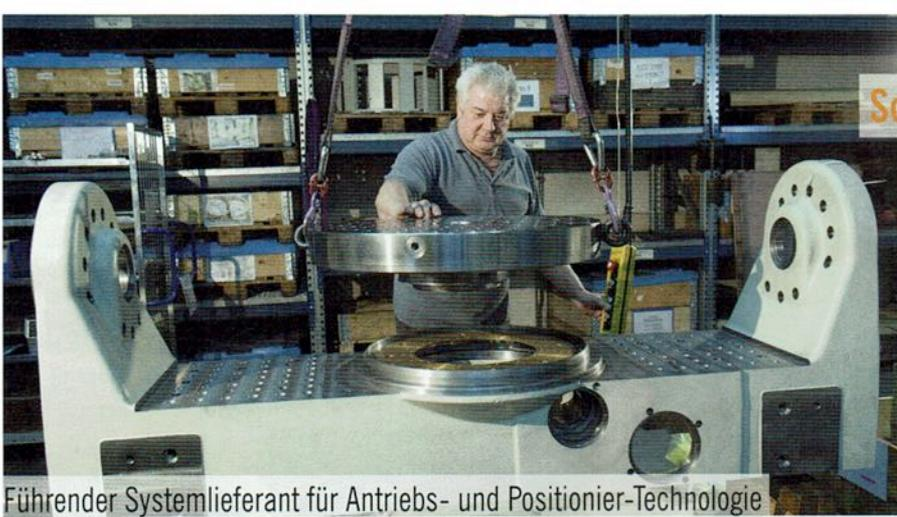
**Bild 1.** Ein Peiseler-Mitarbeiter bei der Montage einer Zweiachs-Schwenkeinrichtung, die zu den Top-Produkten des Unternehmens gehört.
