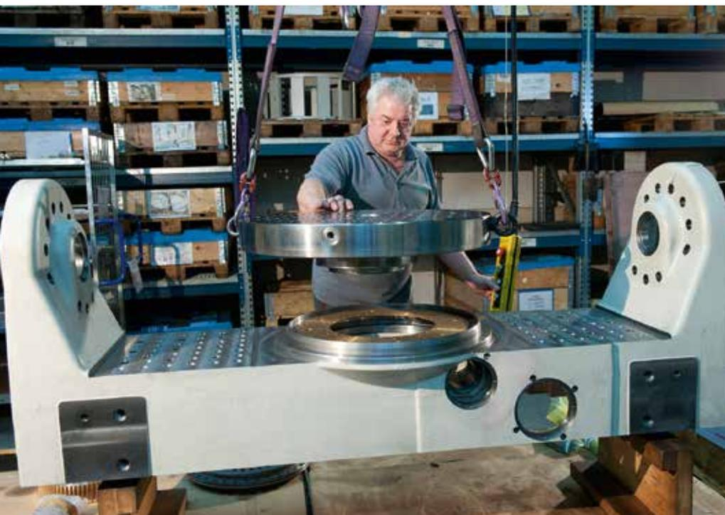
**1** Ein Peiseler-Mitarbeiter bei der Montage einer Zwei-Achs-Schwenkeinrichtung, die zu den Top-Produkten des Unternehmens gehört (Bild: Peiseler)
