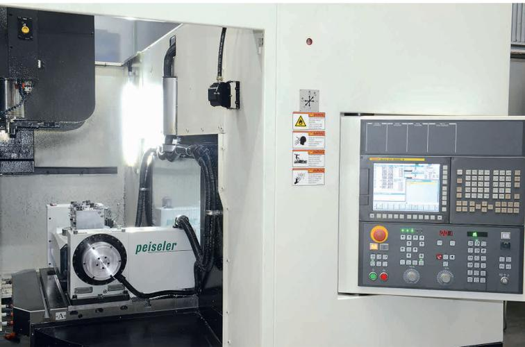
**3** Die eine Hälfte des Wechseltisches mit einer der beiden Zweiachs-Schwenkeinrichtungen von Peiseler. Hinter der Scheibe ist die gerade im Maschinenraum positionierte Seite des Palettenwechslers zu sehen. Durch die hauptzeitparallele Spannmöglichkeit konnte Avci den Output um 20 Prozent steigern © Peiseler
