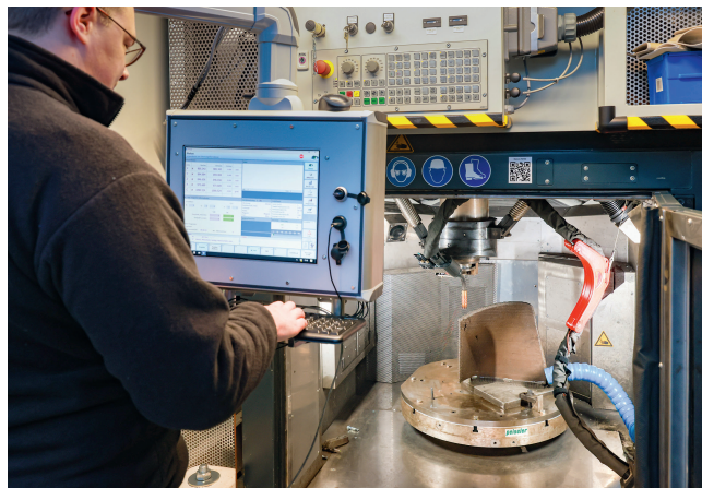
6 Programmierung für die Fertigung eines Rührflügels, der auf dem Peiseler-Rundtisch in der Mobile Smart Factory montiert ist © Peiseler
