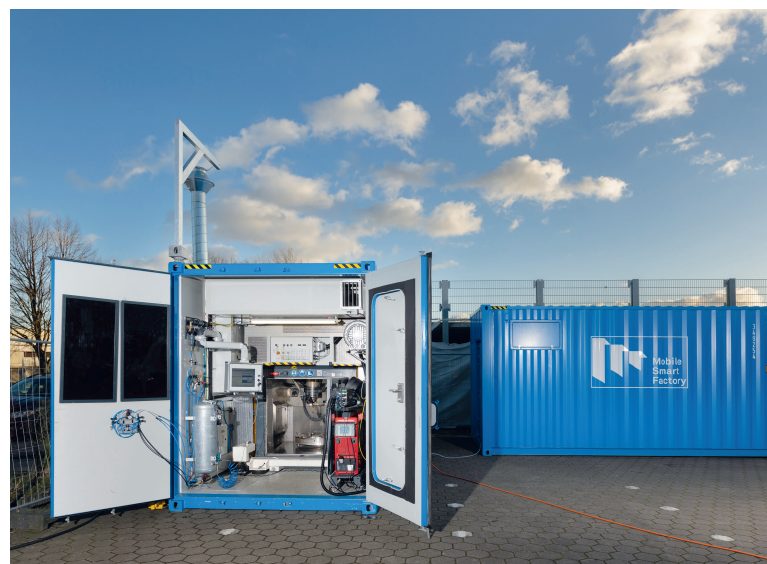
2 Die Mobile Smart Factory besteht aus zwei Containern. Einer mit der Anlage für die additive Fertigung und die Fräsarbeiten sowie dem Peiseler-Rundtisch zur Positionierung der Werkstücke (links im Bild). Der andere Container dient zur Arbeitsvorbereitung und Steuerung der Anlage sowie als Materiallager © Peiseler
