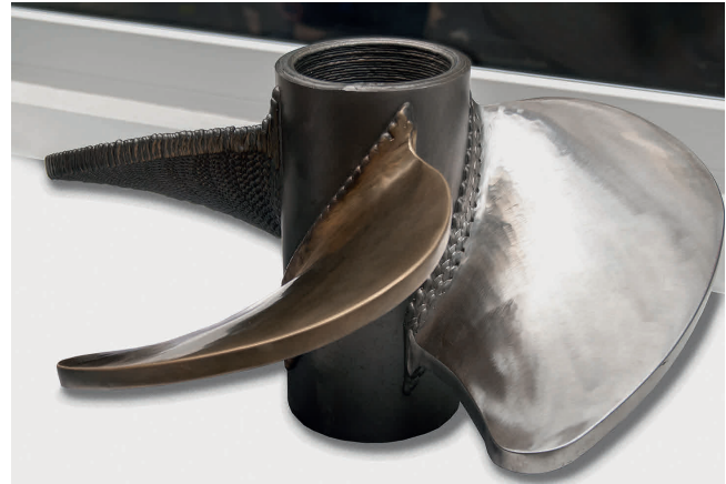
3 Mit 3DMP generativ gefertigte Schiffsschraube, deren hinterer Flügel noch nicht final bearbeitet ist und deutlich die mit dem geschmolzenen Draht aufgetragenen Lagen zeigt (© Peiseler)
