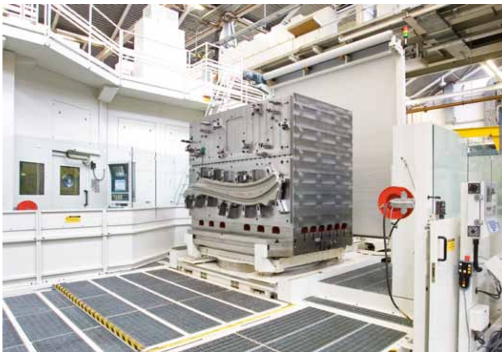
Auf diesen Spannkubus aus Stahl spannen Mitarbeiter von Premium Aerotec die zu bearbeitenden Teile. Bis zu 28 Tonnen wiegt der gesamte Aufbau, den der Peiseler-Drehtisch mühelos bewegt.
