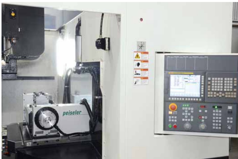
Die eine Hälfte des Wechseltisches mit einer der beiden Zweiachs-Schwenkeinrichtungen von Peiseler. Hinter der Plexiglasscheibe ist die gerade im Bearbeitungsraum positionierte Seite des Palettenwechslers zu sehen. Durch diese hauptzeitparallele Spannmöglichkeit konnte AVCI den Output um 20 Prozent steigern.
