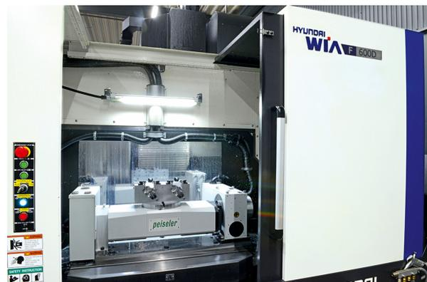
Die Peiseler-Schwenkeinrichtung in der Werkzeugmaschine von Hyundai WIA bei AVCI in Solingen. Erstmals setzte das Remscheider Unternehmen mit dieser Lösung eine mittig platzierte Planscheibe um und realisiert damit einen größeren Störkreis. (Bildnachweis: Peiseler)
