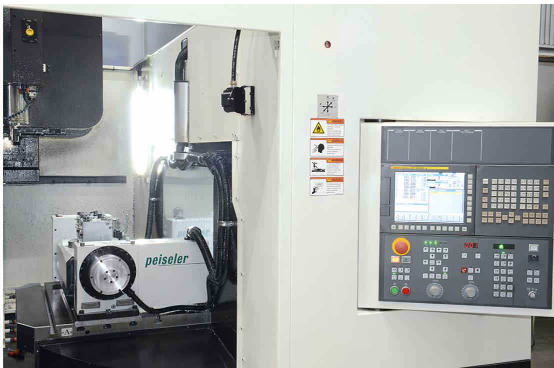
Die eine Hälfte des Wechseltisches mit einer der beiden Zweiachs-Schwenkeinrichtungen von Peiseler. Hinter der Plexiglasscheibe ist die gerade im Bearbeitungsraum positionierte Seite des Palettenwechslers zu sehen. Durch diese hauptzeitparallele Spannmöglichkeit konnte AVCI den Output um 20 Prozent steigern. (Bildnachweis: Peiseler)
