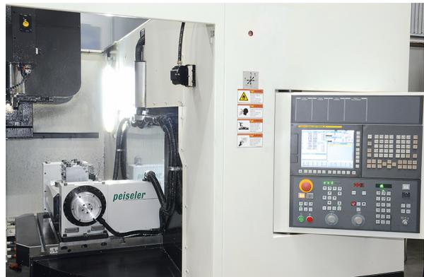
Die eine Hälfte des Wechseltisches mit einer der beiden Zweiachs-Schwenkeinrichtungen von Peiseler. Hinter der Plexiglasscheibe ist die gerade im Bearbeitungsraum positionierte Seite des Palettenwechslers zu sehen. Durch diese hauptzeitparallele Spannmöglichkeit konnte AVCI den Output um 20 Prozent steigern. (Bildnachweis: Peiseler)
