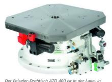
Der Peiseier-Dreinisch ALD 400 ist in der Lage, in einer Sekunde zwei Spindeln zu je 130 Kilogramm bei einer Drehung um 180 Grad mit einer Wiederholgenauigkeit von 0,1 Winkelsekunden zu positionieren.
